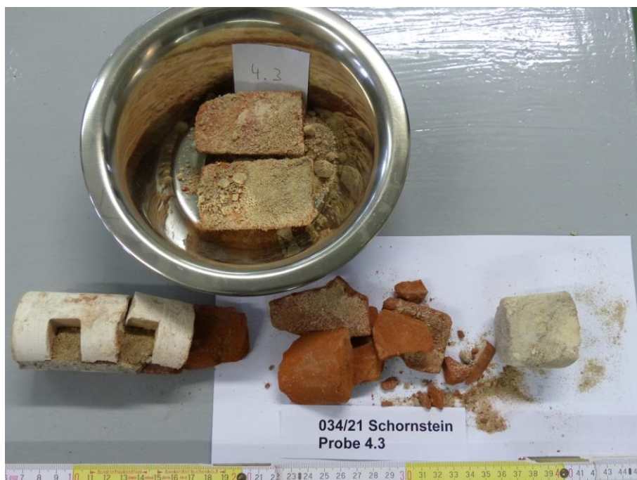
Bild A2-20: Probe 4.3, Probe stark zerfallen, Bohrung auf Fuge
