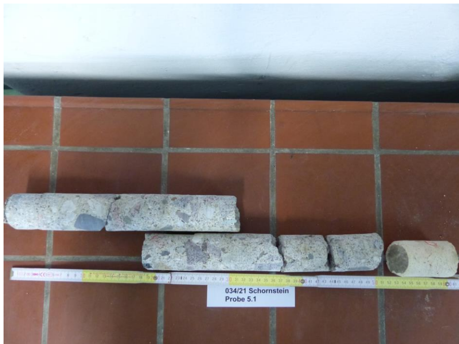
Bild A2-24: Probe 5.1 Bohrung Betonsockel (hinter Beton Schamotte)
