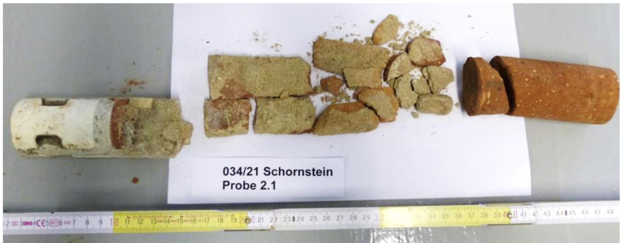
Bild 24: Bohrkern durch die tragende Ziegelschale, mit zerfallendem Fugenmörtel ([15])
