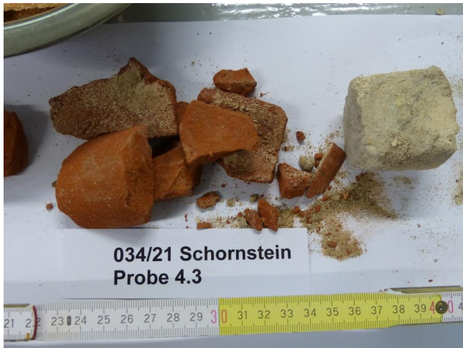
Bild A2-23: wie vor Detail: Fuge Ziegelmauerwerk, dahinter Schamotte
