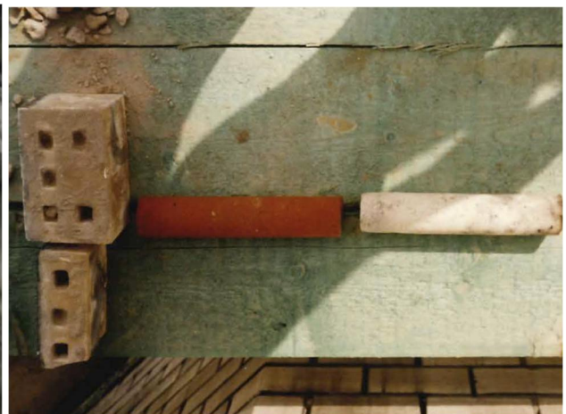
Bild 5: Bohrkern mit Schamotte (weiß, rechts), Trag- und Hochloch-Verblenderziegel (rot) und glasiertem Hochloch-Verblenderziegel
