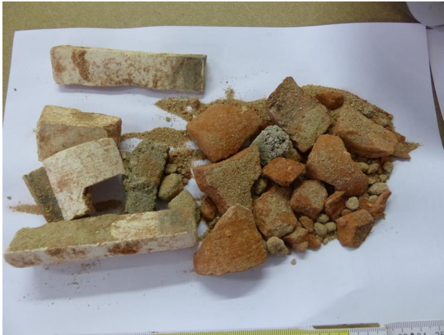
Bild A2-17: wie vor Detail: Verblendstein und Ziegel
