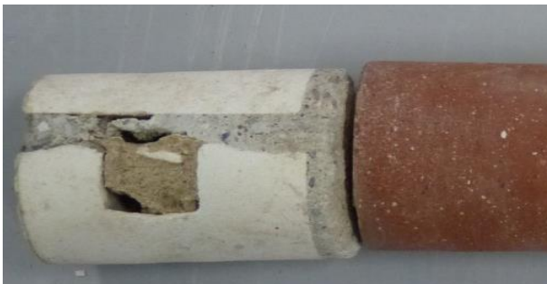
Bild 12: Bohrkern MS 3.3, Zementmörtel und Kalkmörtel im Hochloch
