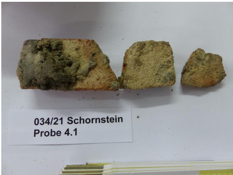
Bild A2-18: wie vor Detail: sehr weicher Mörtel in Fuge Ziegelmauerwerk (sandähnlich)
