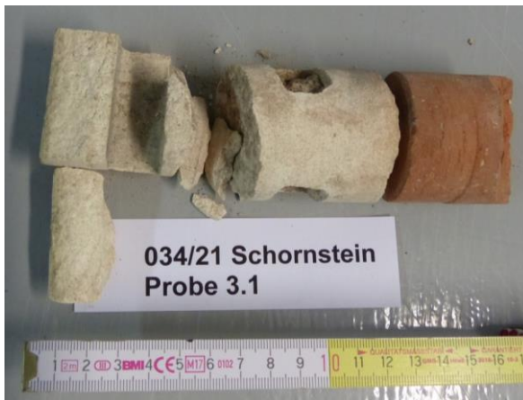
Bild 17: BK 3.1, Riss nur in Verblendung
