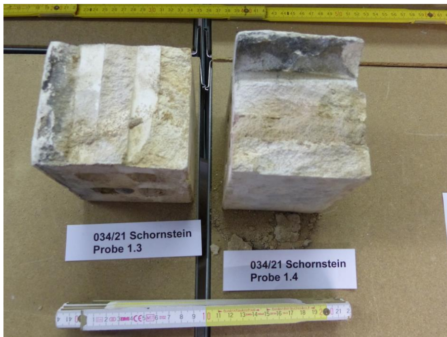
Bild A2-07: Proben 1.3 und 1.4, Bruchfläche (händisch zugehauene Steine)
