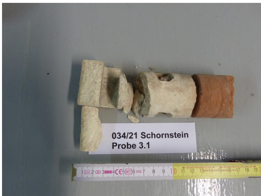
Bild A2-10: Probe 3.1, Bohrung auf Riss
