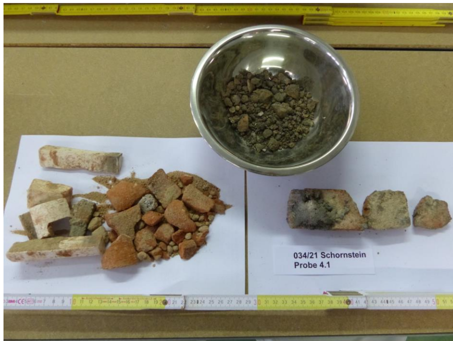
Bild A2-15: Probe 4.1, Probe stark zerfallen, Bohrung auf Fuge
