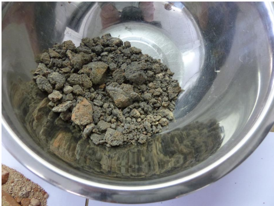
Bild A2-16: wie vor Detail: Reste von Mörtel und Ziegelbruch
