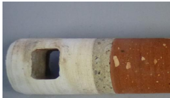
Bild 13: Bohrkern MS 2.2, intakte Stoßfuge zum Hauptmauerwerk aus Zementmörtel
