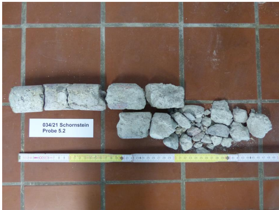
Bild A2-25: Probe 5.2 Bohrung Betonsockel, Probe stark zerfallen
