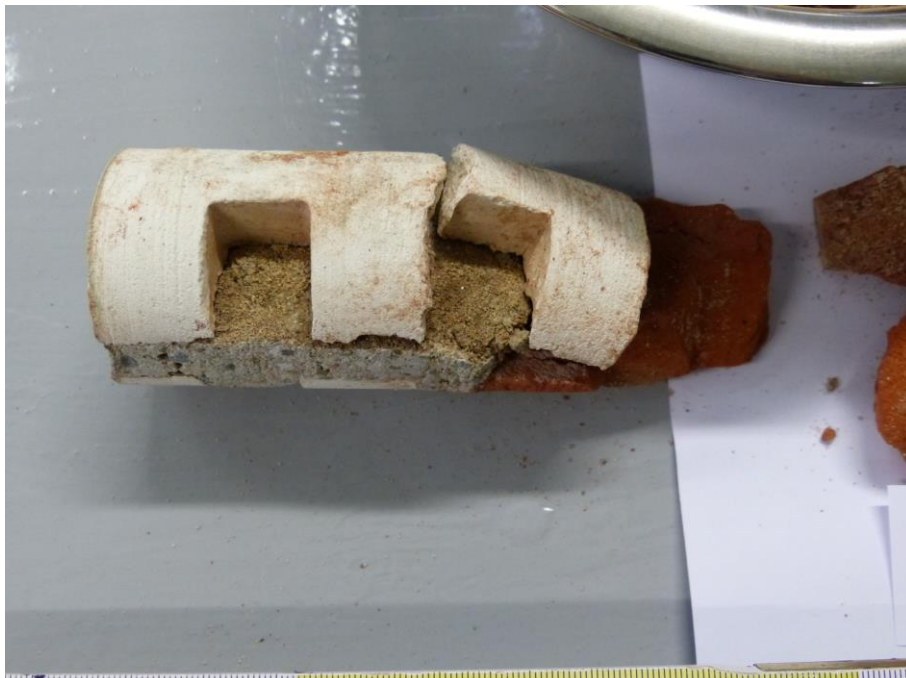
Bild A2-22: wie vor, Detail: Fuge Verblendstein, „alter“ und „neuer“ Mörtel
