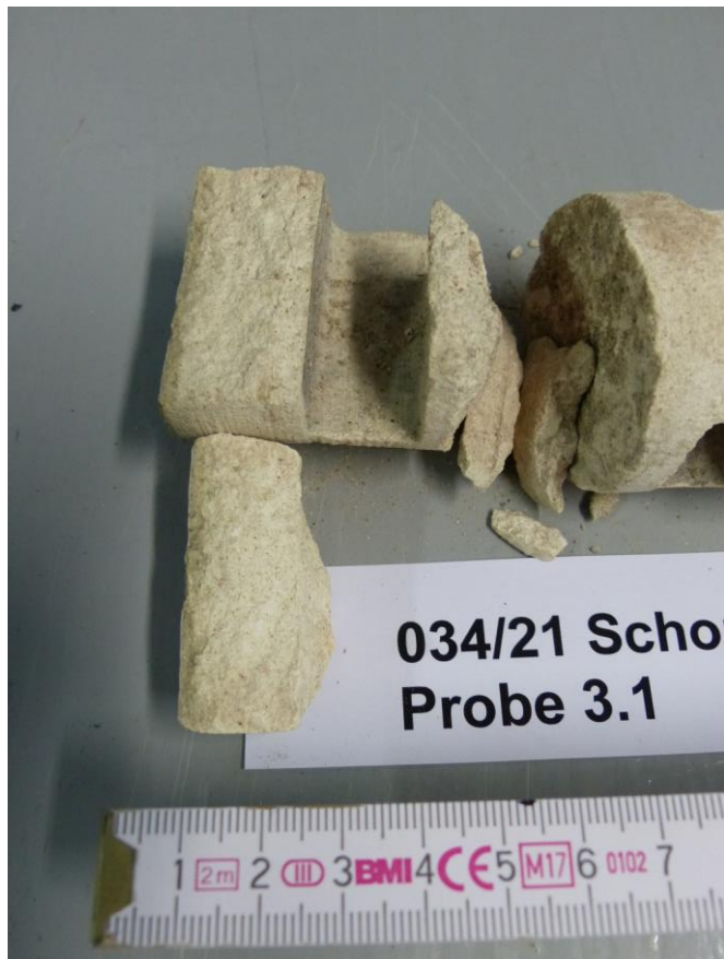
Bild A2-11: Detail: Bohrung auf Riss – Riss nur in Verblendstein
