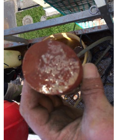
Bild 16: MS 3.2, Ziegel des Hauptmauerwerks ist intakt
